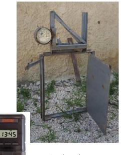
Système à ouverture mécanique, commande par réveil 50% des agriculteurs équipés
