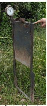
Système à fermeture mécanique, commande par réveil
