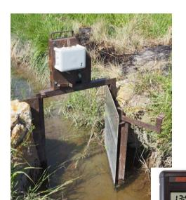
Système à ouverture mécanique, commande par boîtier électronique 10% des agriculteurs équipés
