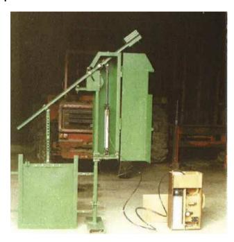
Système à ouverture et fermeture facilitées par vérins pneumatiques 10% des agriculteurs équipés
